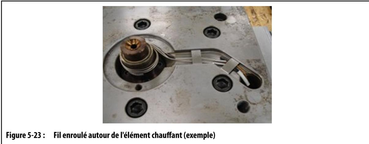
**Figure 5-23 : Fil enroulé autour de l'élément chauffant (exemple)**
