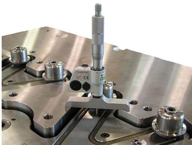
**Figure 5-17 : Mesure de précharge**
