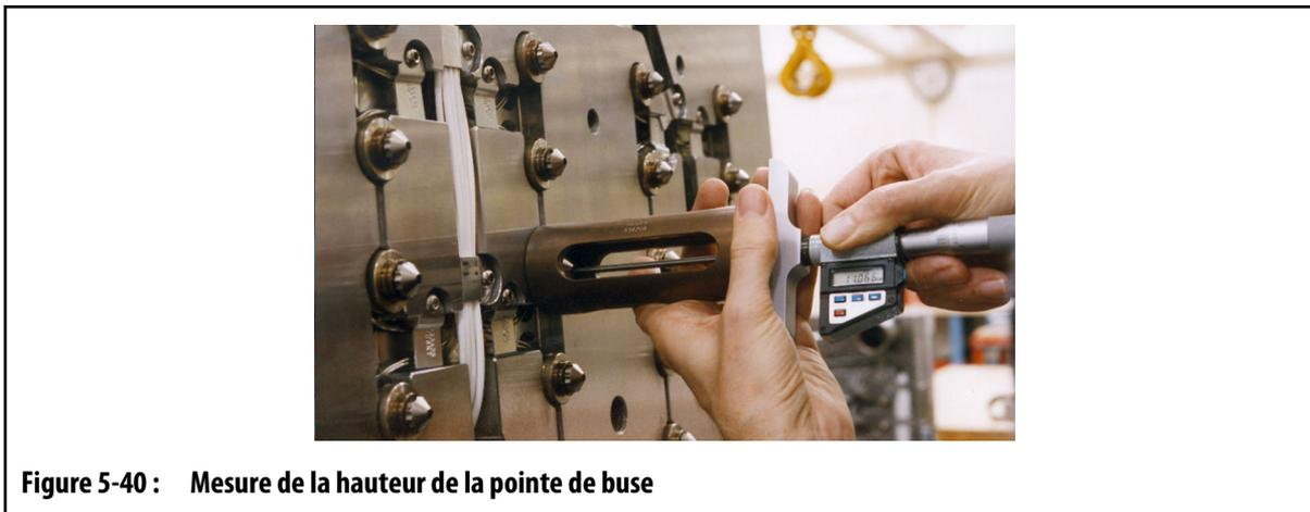
**Figure 5-40 : Mesure de la hauteur de la pointe de buse**
