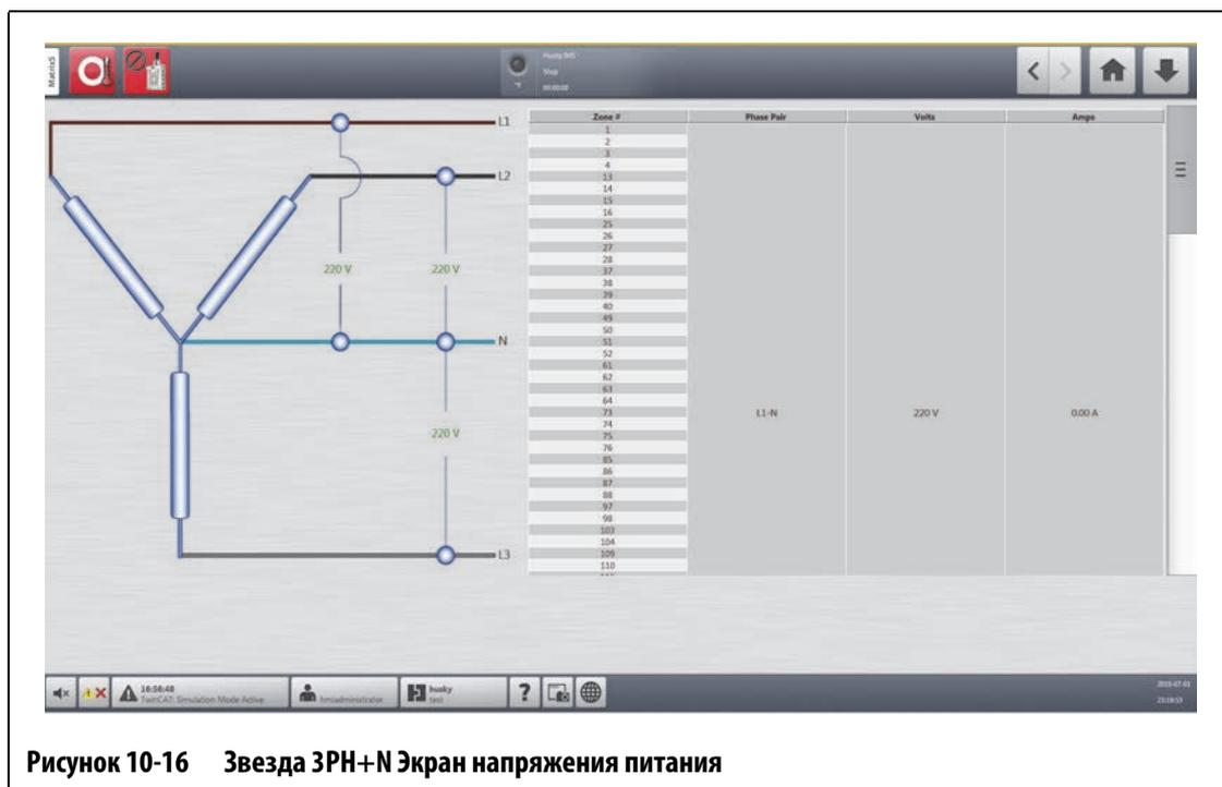
Рисунок 10-16 Звезда ЗРН+N Экран напряжения питания
