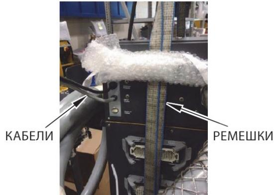
**Рисунок 1-3 Проверка кабелей**
