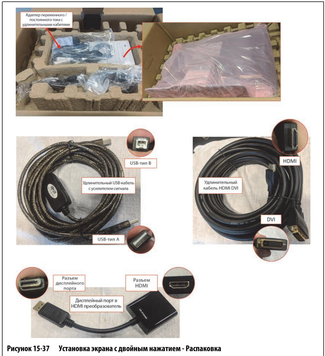
4. Подключите удлинительный USB-кабель (USB-разъем типа A) к одному из доступных USB-портов в нижней части корпуса БУД. См. [Рисунок 15-38](#).
