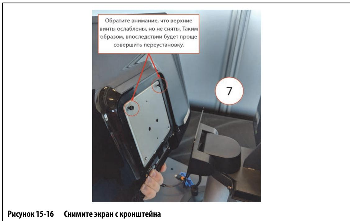
11. При установке сменного экрана убедитесь, что винты предварительно установлены на верхние резьбовые шпильки, а также что винты оставлены на нижних шпильках на задней панели сенсорного экрана.
