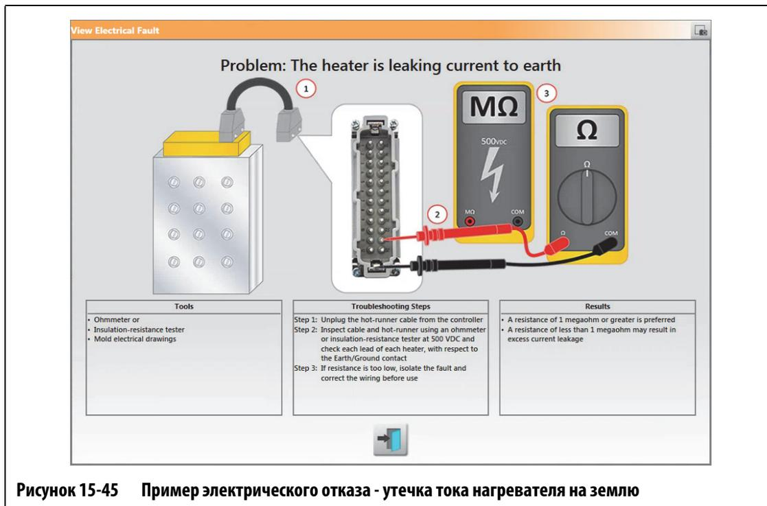
Рисунок 15-45 Пример электрического отказа - утечка тока нагревателя на землю
