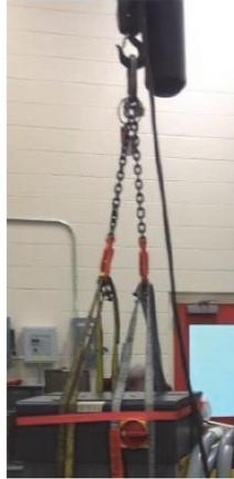
**Рисунок 1-1** Прикрепите ремни к подъемному устройству
