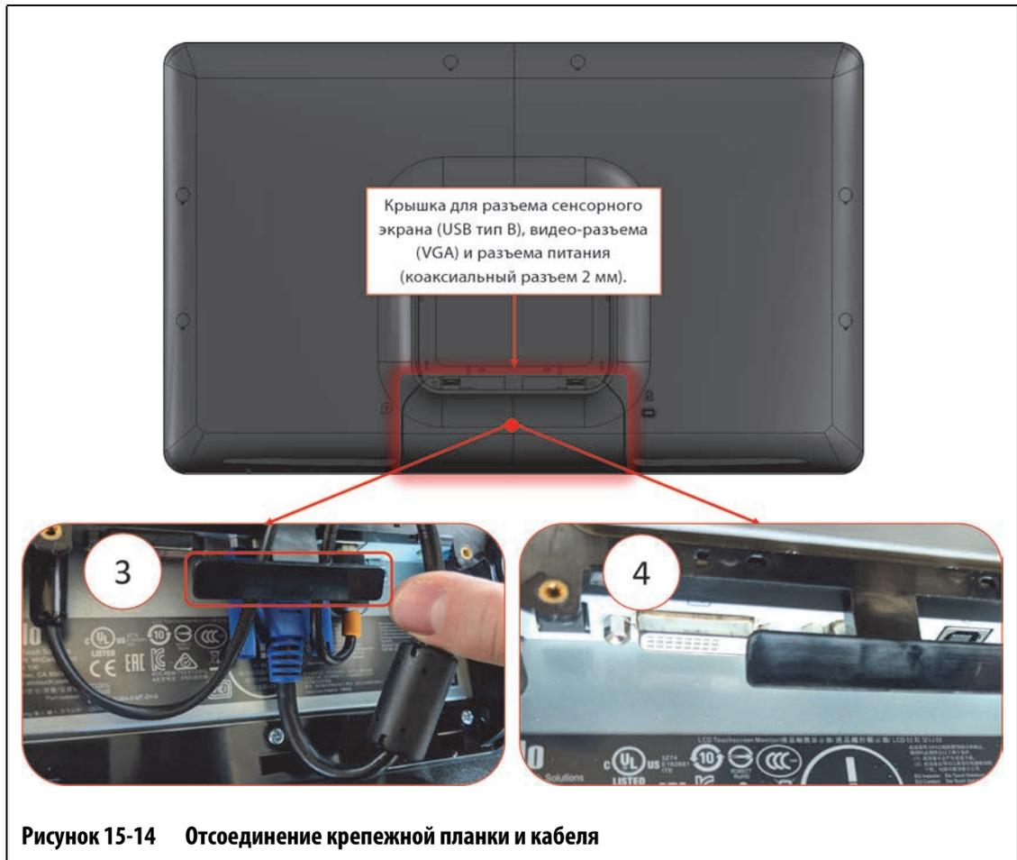
7. После того как кабели отсоединятся от удерживающей планки, отсоедините разъем питания, видеоразъем (этот разъем удерживается винтами, которые можно выкрутить небольшой щелевой отверткой) и разъемы сенсорного экрана. См. сноску 4 в [Рисунок 15-14](#).
