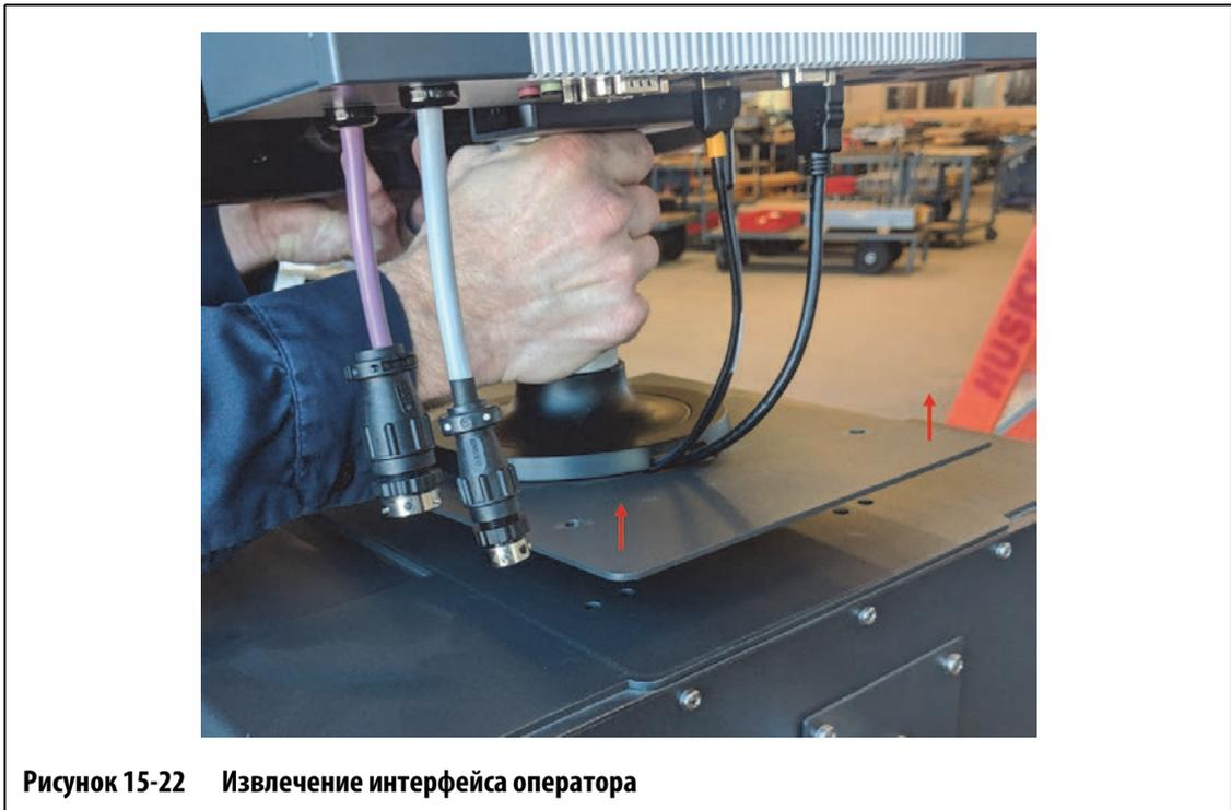
Рисунок 15-22 Извлечение интерфейса оператора
