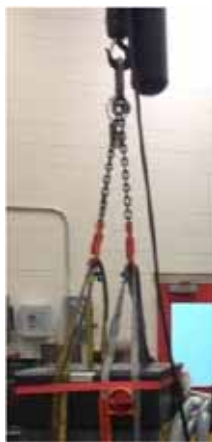
Figura 1-1 Collegare le cinghie al dispositivo di sollevamento
