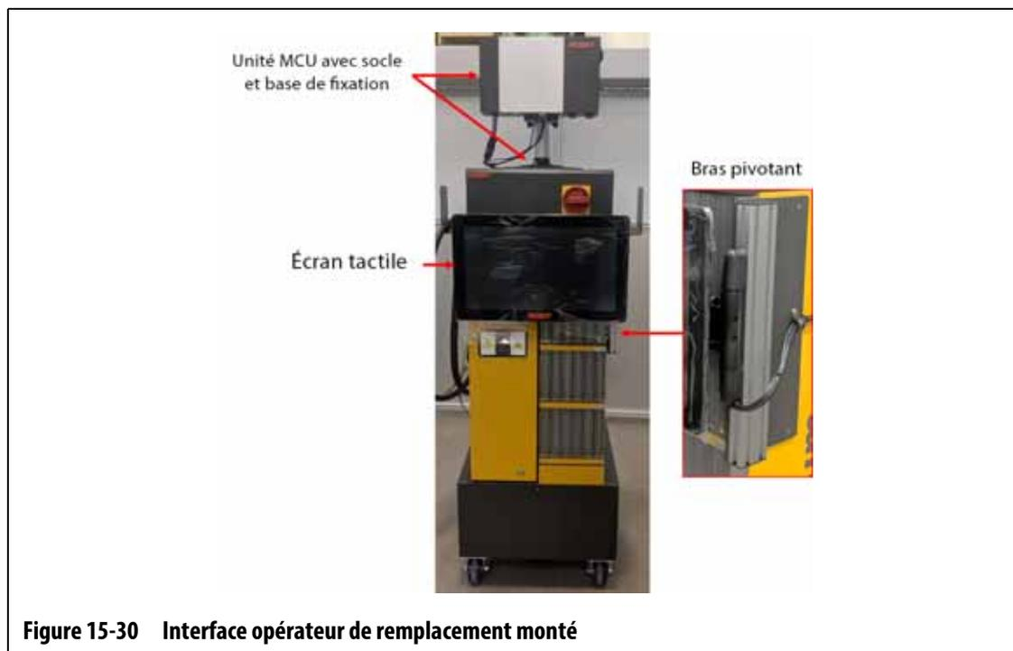
**Figure 15-30** Interface opérateur de remplacement monté
