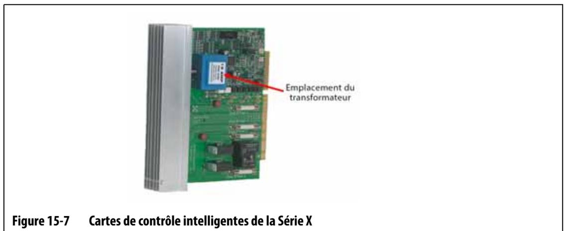
Figure 15-7 Cartes de contrôle intelligentes de la Série X
