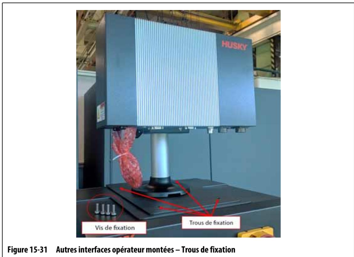
**Figure 15-31 Autres interfaces opérateur montées – Trous de fixation**
