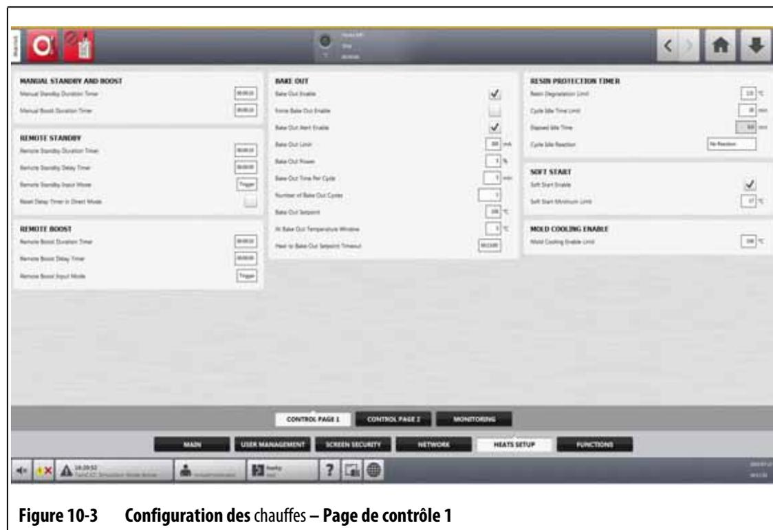
**Figure 10-3** Configuration des chauffes – Page de contrôle 1
