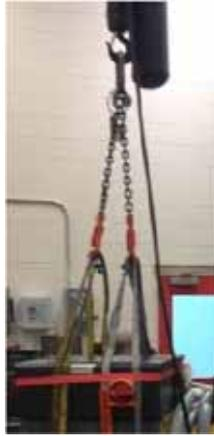
**Figure 1-1** Fixez les sangles à l'appareil de levage
