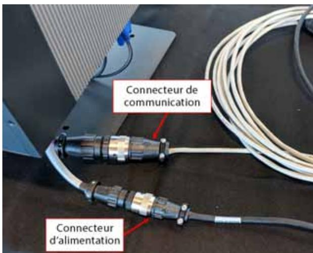
**Figure 15-29** Interface opérateur à distance – Branchement du câble de l'unité MCU
