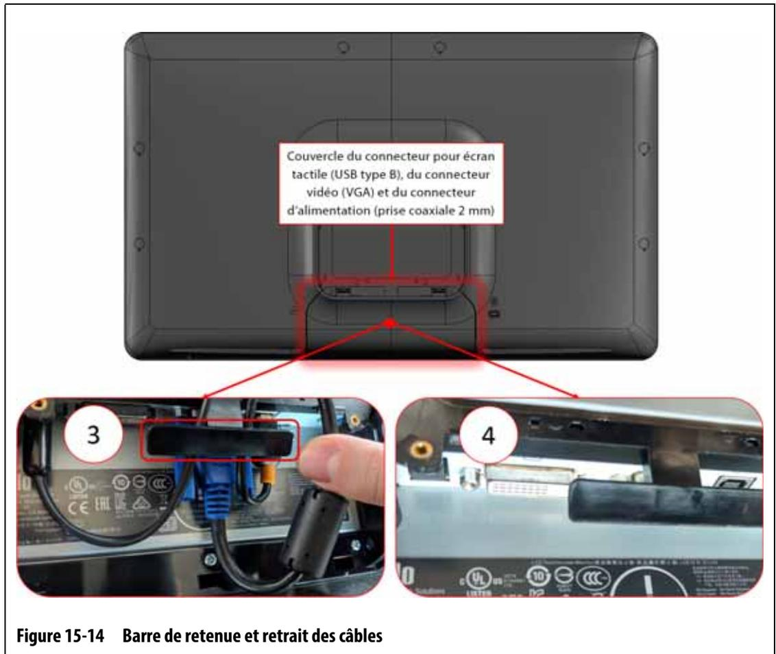
7. Une fois que les câbles sont dégagés de la barre de retenue, mettez hors tension les connecteurs d'alimentation, vidéo (ce connecteur est maintenu par des vis et peut nécessiter un petit tournevis à fente pour le retirer) et de l'écran tactile. Veuillez-vous reporter au numéro 4 dans [Figure 15-14](#).
