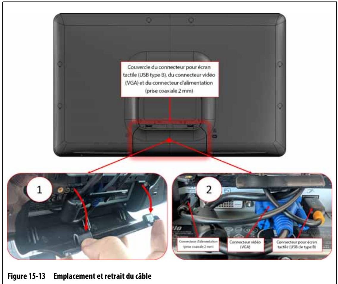
5. Une fois le couvercle retiré, trouvez le connecteur d'alimentation (prise coaxiale 2 mm), le connecteur vidéo (VGA) et le connecteur de l'écran tactile (USB type B). Veuillez-vous reporter au numéro 2 dans [Figure 15-13](#).
