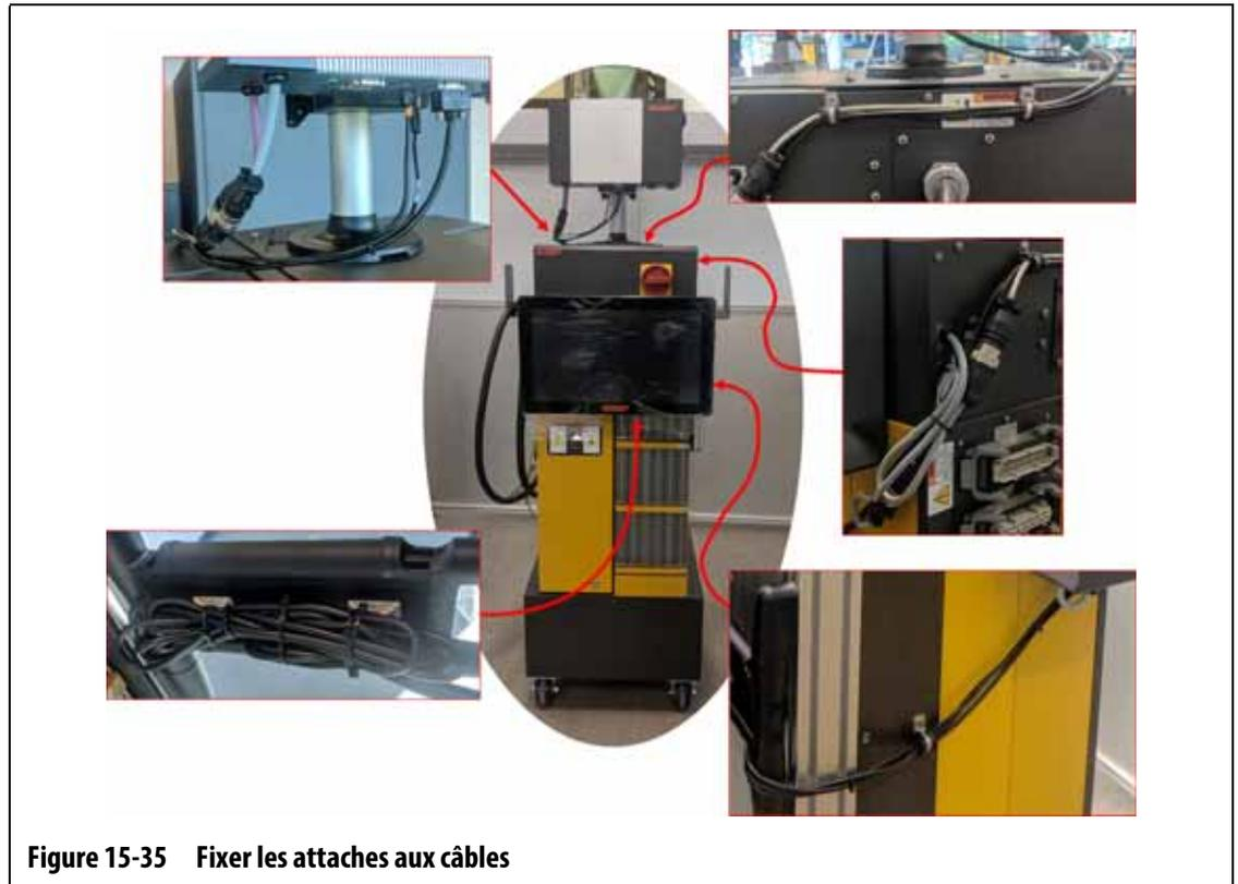
**Figure 15-35** Fixer les attaches aux câbles
