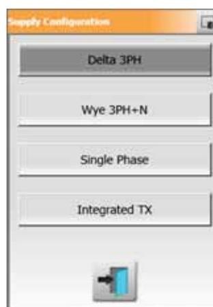
**Figure 10-20** Fenêtre de dialogue sur la configuration de l'alimentation
