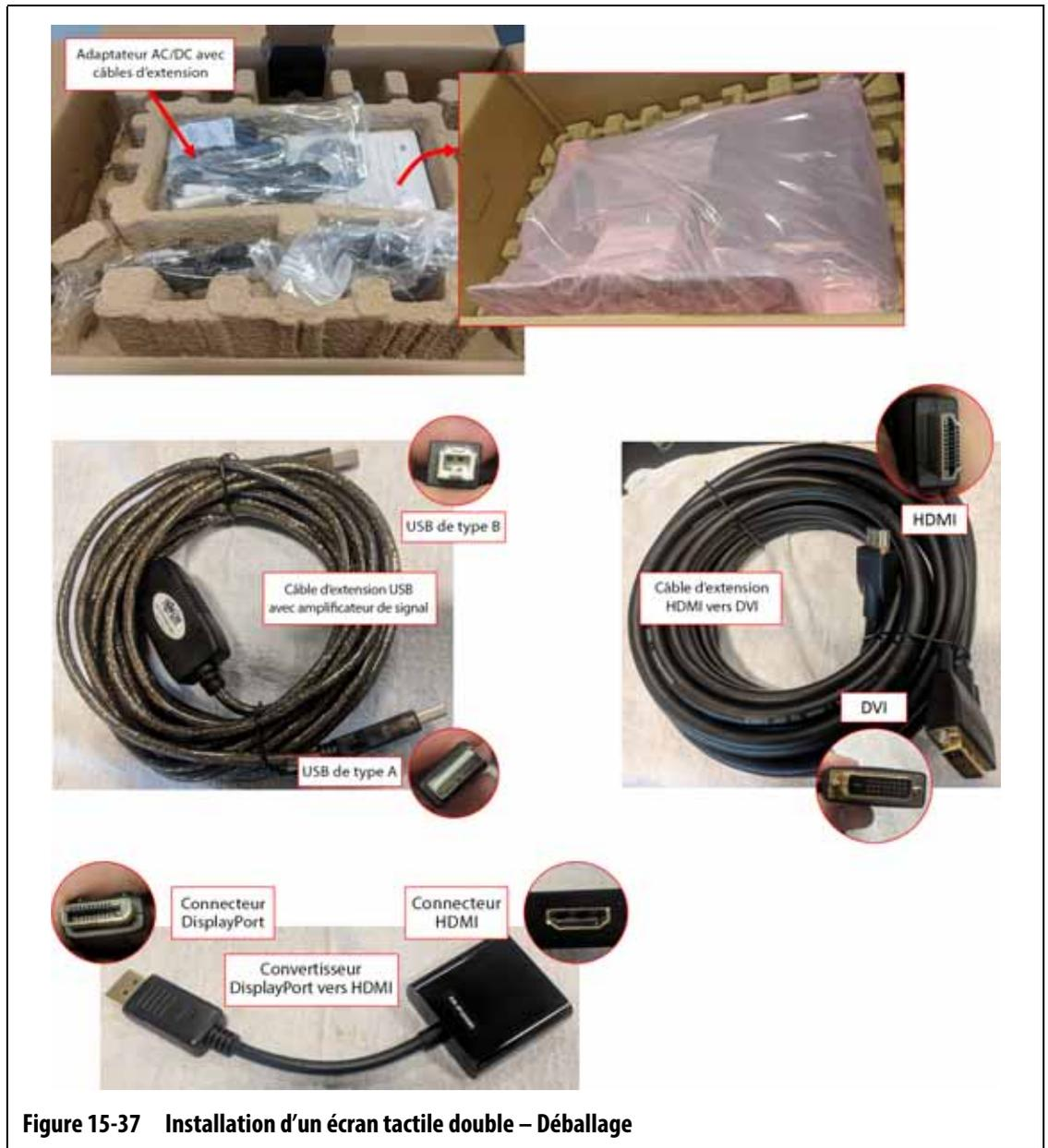
Figure 15-37 Installation d'un écran tactile double – Déballage
