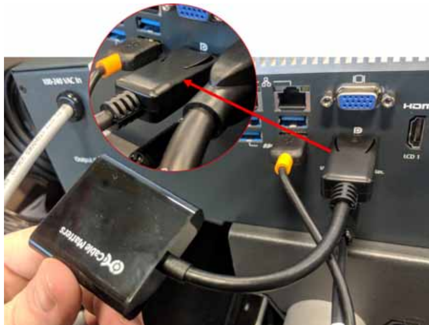
Figura 15-40 Convertor de DisplayPort a HDMI (extremo del conector DisplayPort)
