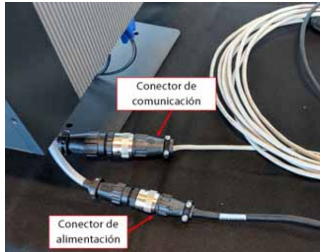
Figura 15-30 Interfaz de operador remota: conexión por cable de la unidad de control principal
