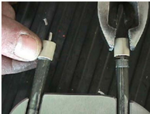
Figura 6-29 Extracción/instalación del casquillo de PEEK
