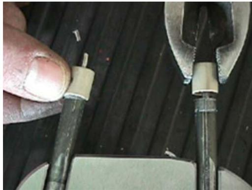
**Figure 6-29** Dépose/installation de douille PEEK
