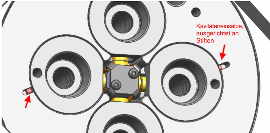
**Abbildung 5 Eigenschaften der Ausrichtung der Kavitäteneinsätze**
