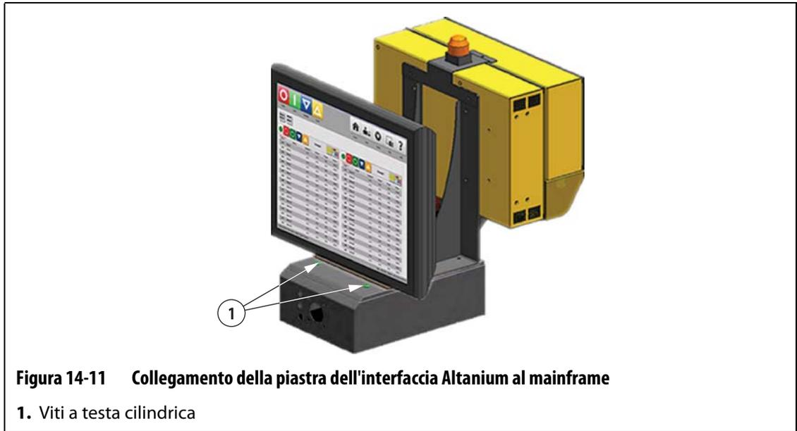
**Figura 14-11 Collegamento della piastra dell'interfaccia Altanium al mainframe**
