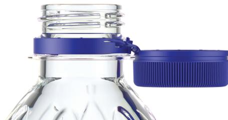
このキャップは、大口径のサポートレッジが特徴の標準PCO 1881ネック仕上げ向けに製造されました。キャップシェルに刻まれた溝により、サポートレッジの干渉を受けずにロックできます。このデザインでは、既存のボトルデザインに合わせた紐付きキャップデザインの柔軟性が特徴です。
