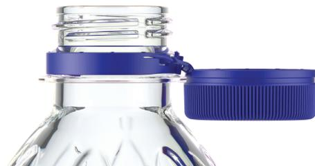
Ce bouchon a été produit pour une bague de goulot PCO 1881 standard qui offre un encorbellement au diamètre large. Une rainure intégrée dans la coquille du bouchon permet de le verrouiller en place sans nuire à l'encorbellement. Cette conception souligne la flexibilité des conceptions de bouchon à attache, qu'elles peuvent se prêter à vos conceptions de bouteille existantes.
