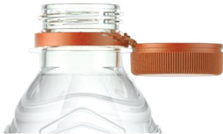
Ce bouchon a été produit pour une bague de goulot PCO 1881 standard. La conception brevetée compte une charnière intégrée qui permet à la coquille d'être verrouillée en place lorsqu'elle est ouverte. Ainsi, elle ne nuit pas lors de la consommation et offre des indices audibles et tactiles agréables.
