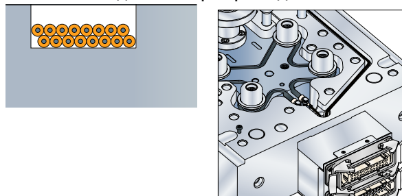
Канавки для электропроводки
