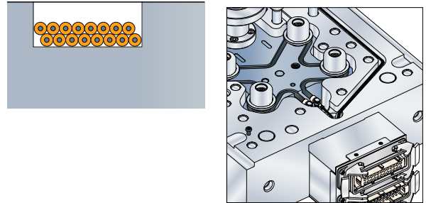
RANURAS PARA CABLEADO
