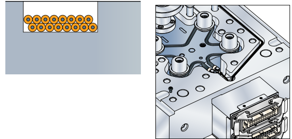
RANURAS PARA CABLEADO
