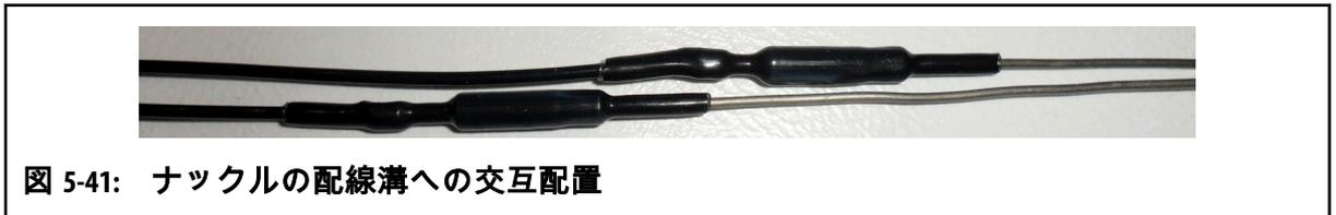
図 5-41: ナックルの配線溝への交互配置
