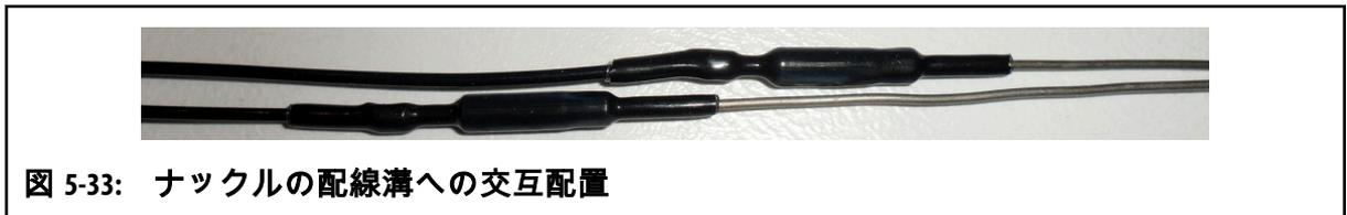
図 5-33: ナックルの配線溝への交互配置
