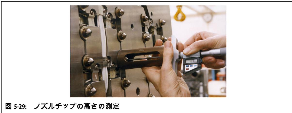
図 5-29: ノズルチップの高さの測定
