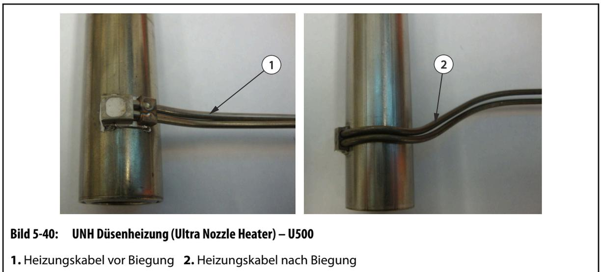
8. Die Kabel für Düsenheizungen und Thermoelemente durch die Kabelkanäle in der Verteilerplatte führen. Sicherstellen, dass alle Kabel durch Kabelklemmen ordnungsgemäß in den Kabelkanälen gesichert sind.
