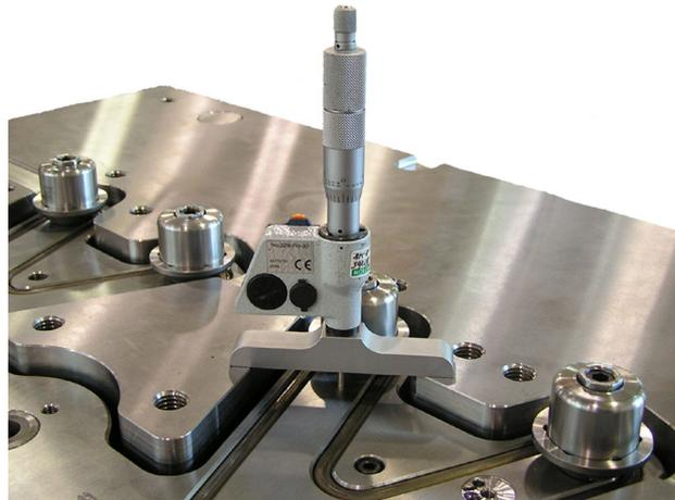
**Figura 6-4: Medição de pré-carga**
