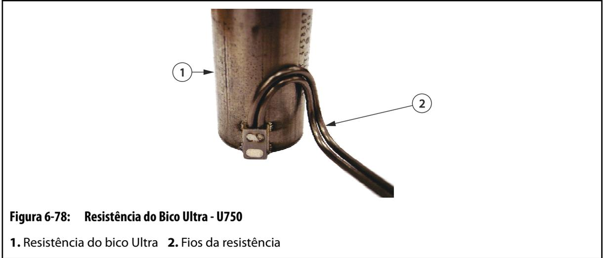
6. Nas resistências U500 , primeiro dobre os contatos ao longo da curvatura da resistência e dobre-os para cima ou para baixo (longe do contato de saída do corpo da resistência) para alcançar os canais de fios da placa do manifold conforme necessário.
