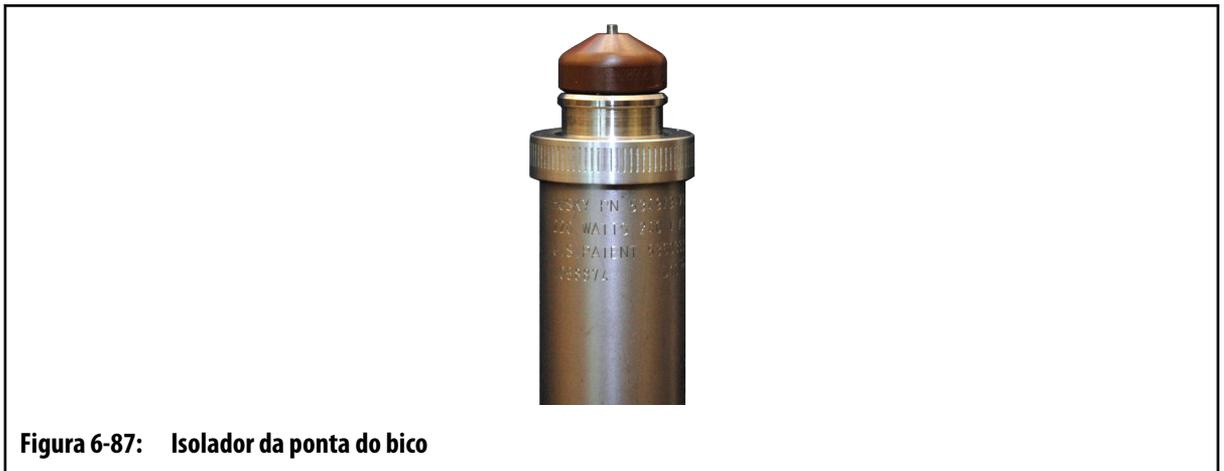
**Figura 6-87: Isolador da ponta do bico**
