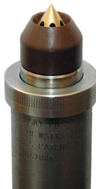
**Figura 6-71: Isolatore punta ugello**
