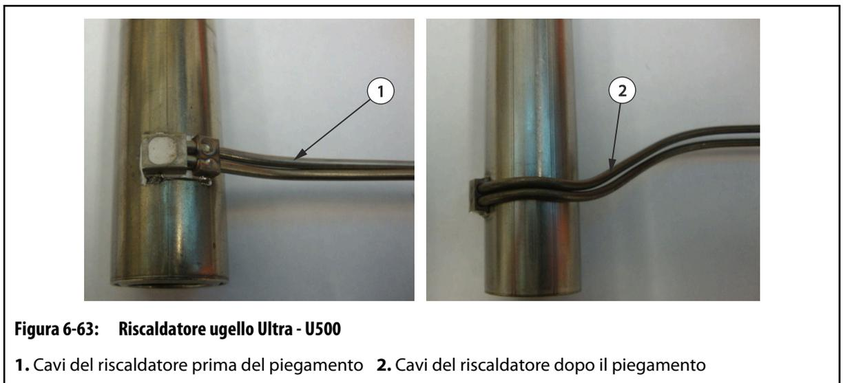
7. Disporre i fili della termocoppia e del riscaldatore dell'ugello attraverso i canali relativi nella piastra del manifold. Assicurarsi che il cablaggio sia fissato correttamente nei canali relativi con gli appositi serrafili.
