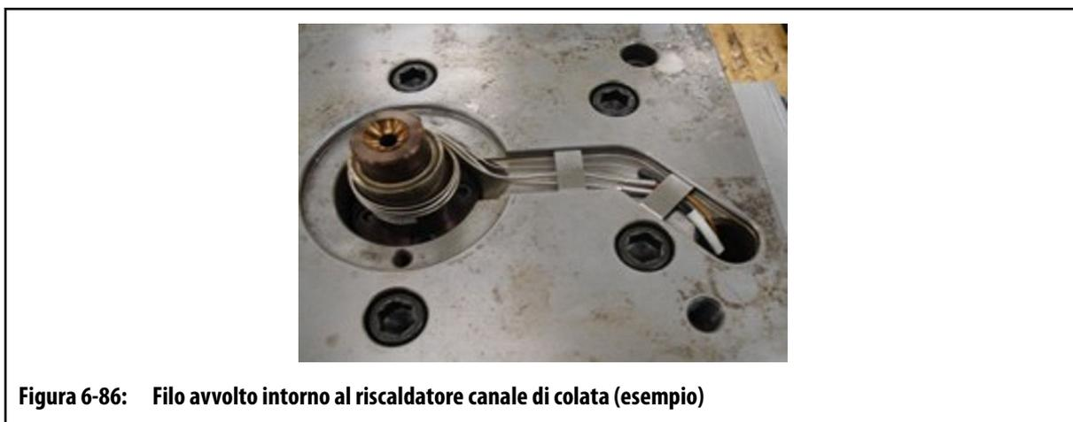
**Figura 6-86: Filo avvolto intorno al riscaldatore canale di colata (esempio)****2. Fili della termocoppia corti**
