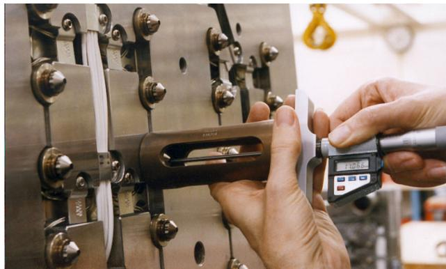
**Figura 6-41: Misurazione dell'altezza delle punte ugelli**
