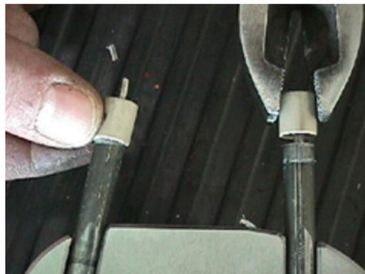
**Figura 6-88: Rimozione e installazione delle boccole in PEEK**
