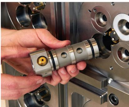
Nuestro sistema de colada caliente Ultra SideGate™ está diseñado para moldeadores que necesitan producir piezas de alta calidad para una gran variedad de resinas donde la compuerta está en una pared lateral.
