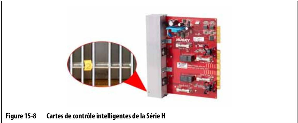
**Figure 15-8** Cartes de contrôle intelligentes de la Série H
