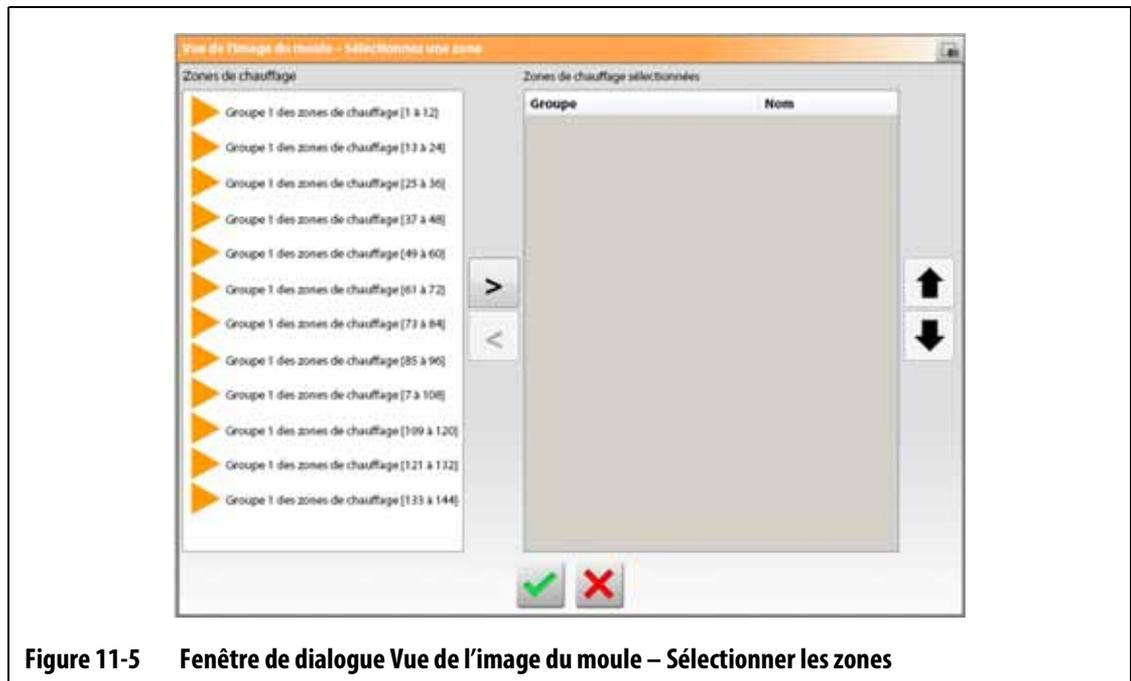
3. Appuyez sur la ou les zones de chauffage pour les mettre en surbrillance. Un panneau d'information sur la zone est créé pour chaque zone de chauffage sélectionnée.
