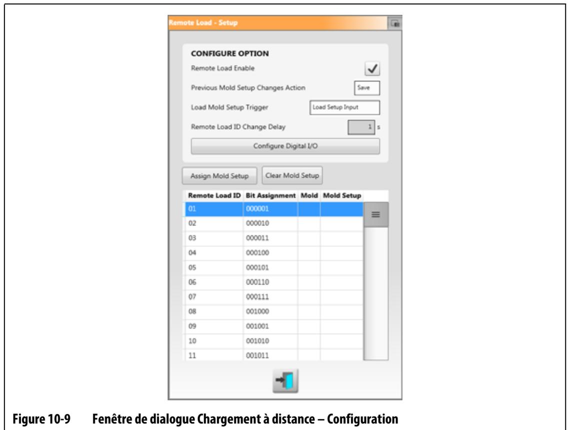
**Figure 10-9 Fenêtre de dialogue Chargement à distance – Configuration**
