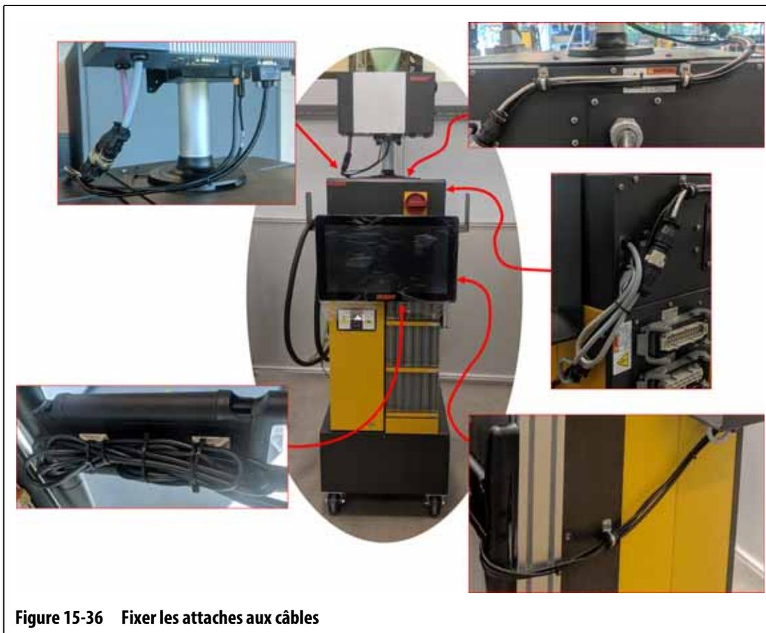
Figure 15-36 Fixer les attaches aux câbles
