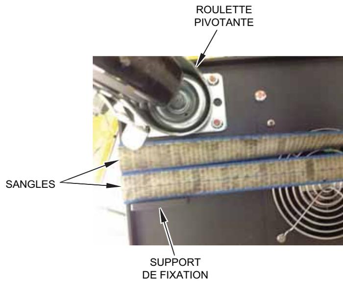
**Figure 1-2** Positionnement des sangles
