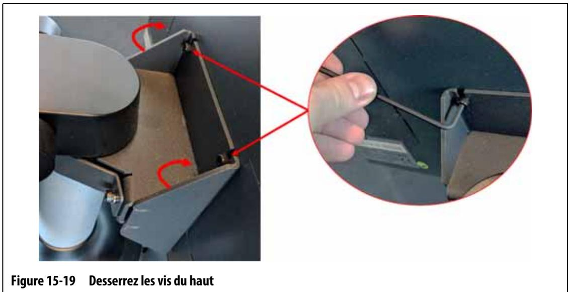
**Figure 15-19** Desserrez les vis du haut
