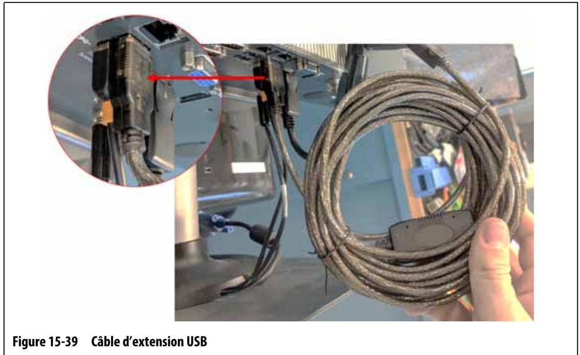
**Figure 15-39** Câble d'extension USB
