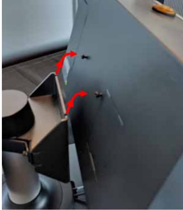
图 15-20 将 MCU 从支架上卸下
