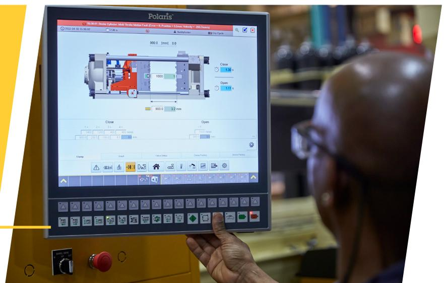
Ein großer Touchscreen ermöglicht die Steuerung auf Systemebene, eine einfache Navigation und eine vereinfachte Bedienung.
