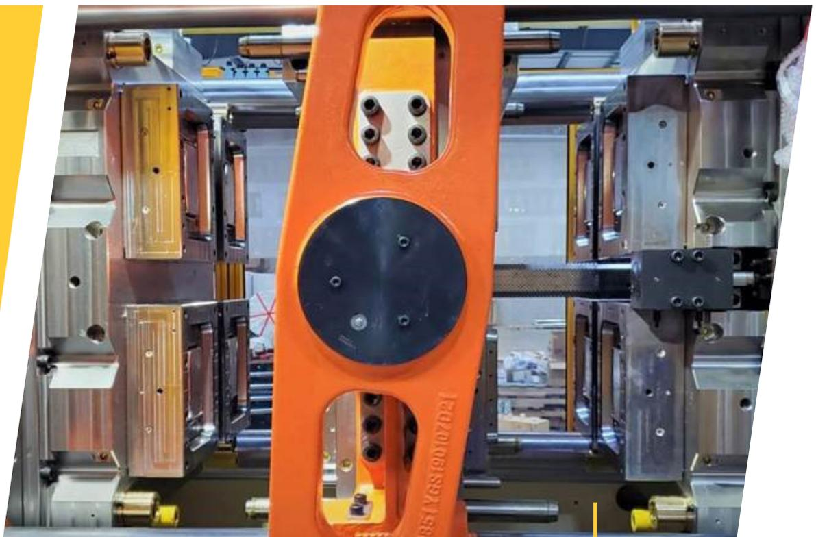
Etagenwerkzeuge (mit zwei oder mehr Trennebenen) können zur Steigerung der Produktivität bei einer Vielzahl von Anwendungen wie Verschlüssen, dünnwandigen Behältern, Deckeln und medizinischen Anwendungen eingesetzt werden.
