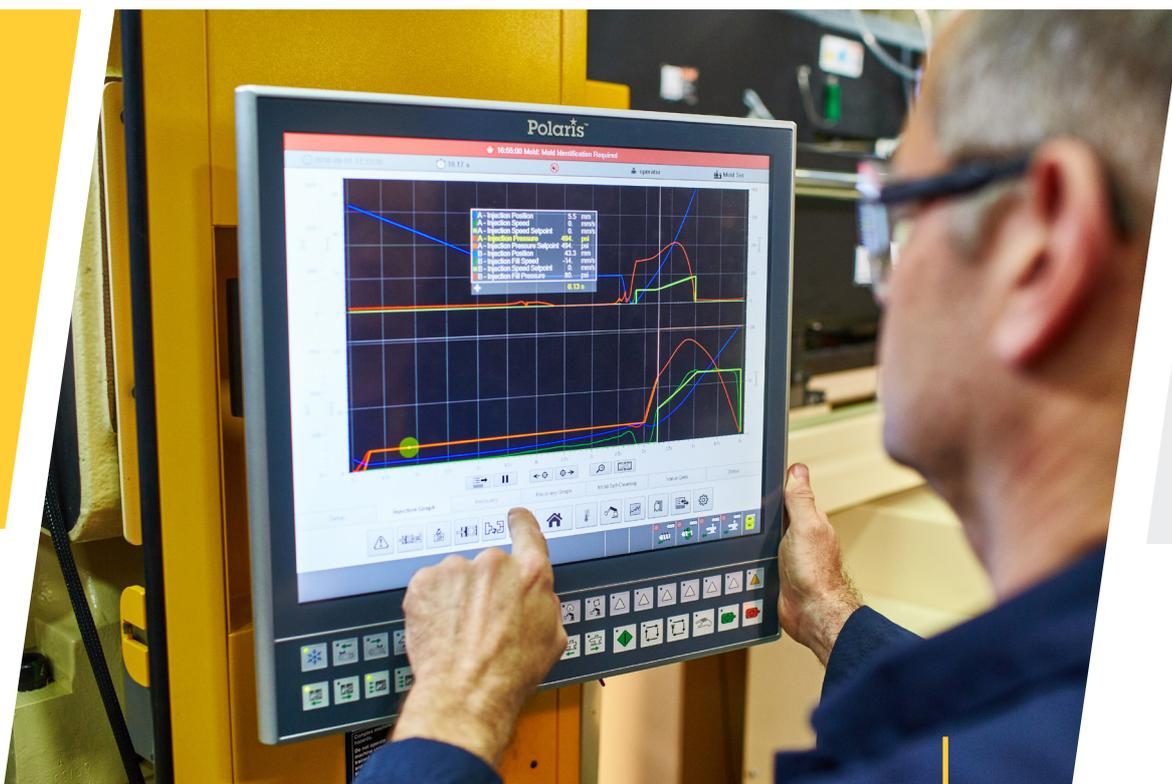
Ein großer Touchscreen ermöglicht die Steuerung auf Systemebene, eine einfache Navigation und eine vereinfachte Bedienung.
