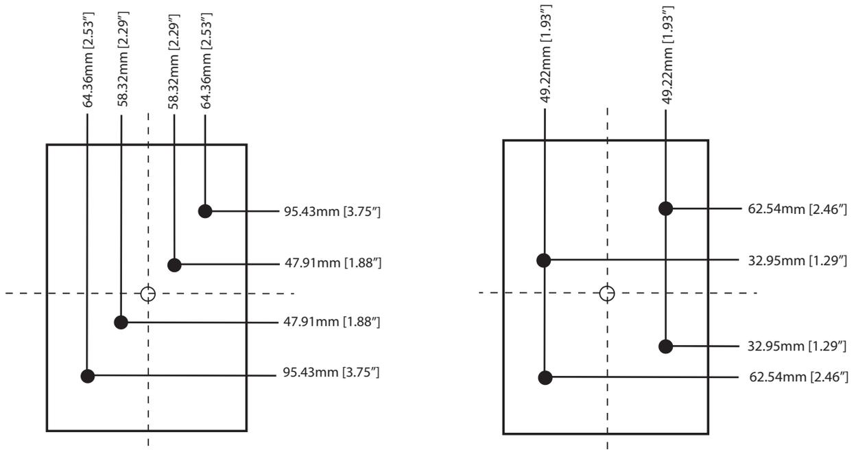
L'emplacement d'espacement pour les systèmes PRONTO à 4 gouttes est disponible pour les configurations symétriques et asymétriques. Les dispositions asymétriques exigent toujours que l'injection se trouve au centre du moule. Tel que l'indique l'exemple, les emplacements de goutte doivent avoir les mêmes dimensions dans les deux quadrants. Par exemple, les gouttes intérieures se trouvent toutes deux à (58.32, 47.91) et les gouttes extérieures se trouvent toutes deux à (64.36, 95.43)
