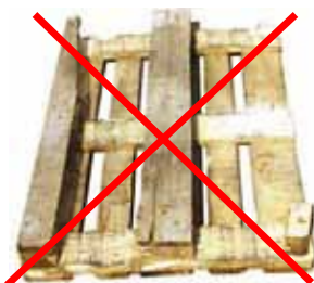
Bottom Edge Board Missing
