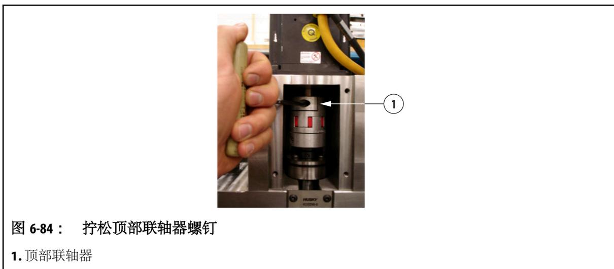
图 6-84： 拧松顶部联轴器螺钉
