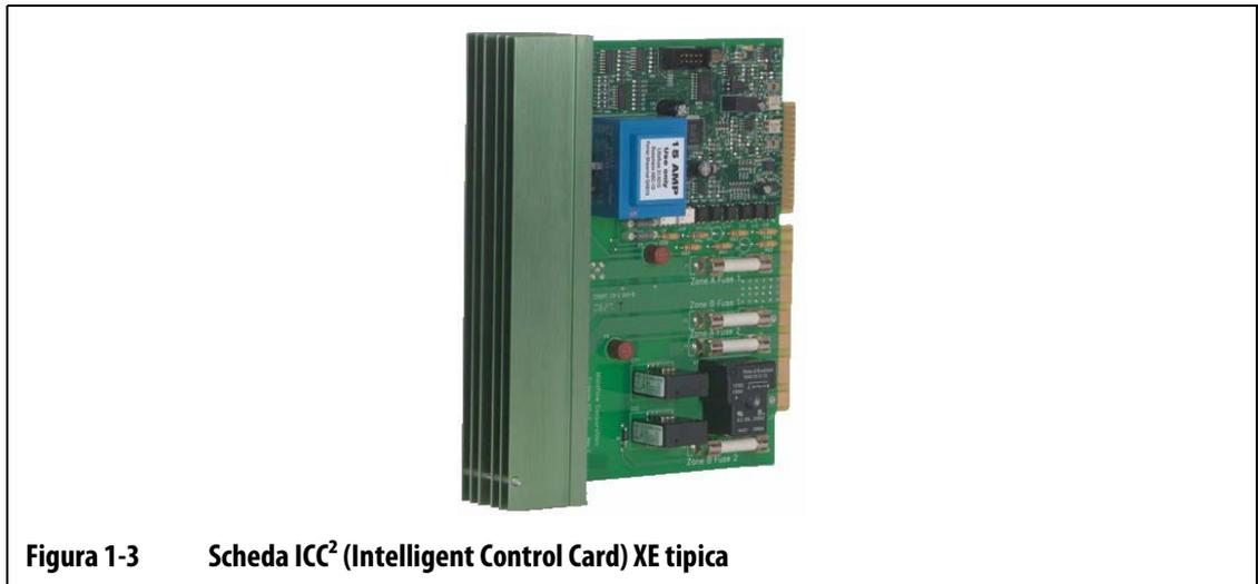
La scheda ICC<sup>2</sup> XE si riconosce grazie al dissipatore di calore verde.
