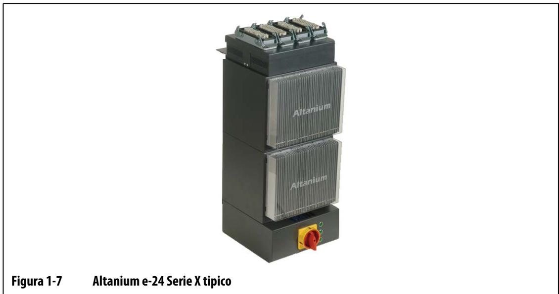
È possibile accedere a tutte le parti riparabili dall'utente, compresi fusibili e circuiti stampati, allentando le viti intagliate superiore e inferiore su ciascun complessivo dissipatore di calore, quindi facendo scorrere il cacciavite tra il montante orizzontale color argento e la sporgenza per estrarre il circuito facendo delicatamente leva.
